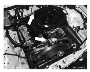
Motor anseilen. Dazu geeignetes Seil oder eine Kette an den Aufhängeösen – Pfeile – des Motors einhängen. Motor mit Werkstattkran leicht vorspannen.
