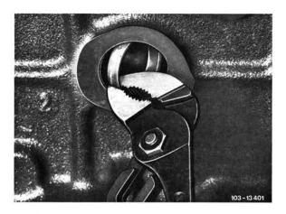
Herausstehenden Deckel mit Rohrzange herausziehen.
