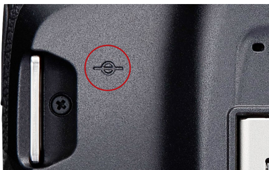
Abb. 1.4 Dieses Symbol zeigt Ihnen die Lage der Sensorebene an.
