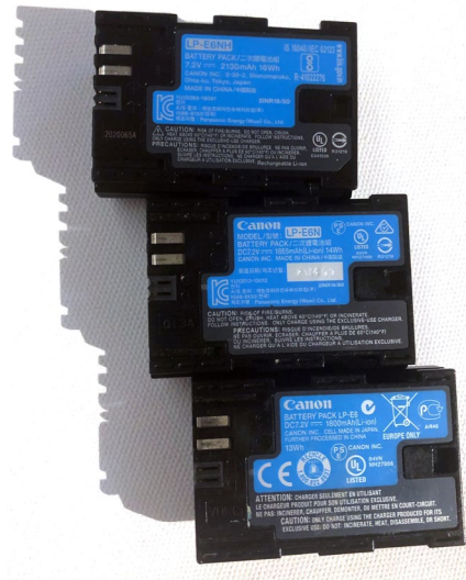
Abb. 1.10 Von der Form her nicht zu unterscheiden, sind die drei Akkuversionen untereinander kompatibel. Aufschluss über die Version gibt das Etikett.
