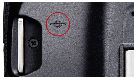
Abb. 1.9 Das Symbol der Linie mit dem Kreis zeigt von oben die Sensorebene. Die Markierung ist 22 mm von der Bajonettauflage entfernt, daher auch der Begriff »Auflagemaß«.
