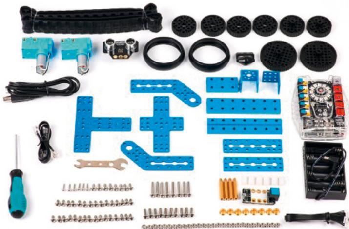
**Bild 2.7** Bestandteile des mBot-Ranger-Kits (© Makeblock Co., Ltd)
