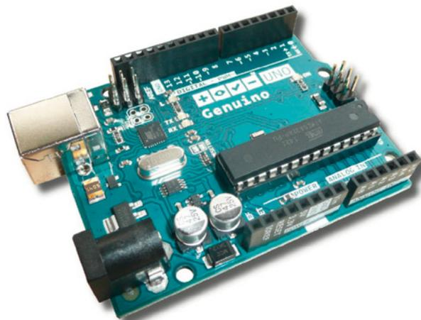
**Bild 2.4** Das Arduino/Genuino-Board
