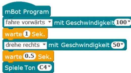
**Bild 2.3** Ein einfaches Scratch-Skript
