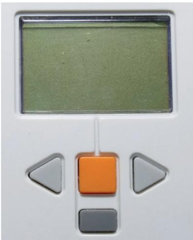
**Abb. 1.7:** Die Kontrollelemente des NXT-Steins
