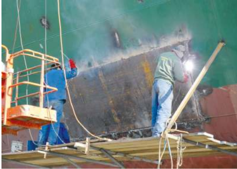
Trabajos de soldadura en el casco de un barco
