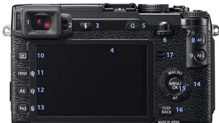
Abb. 3: Rückansicht der X-E2: Elektronischer Sucher mit Dioptrieneinstellrad (1), Augensensor (2), Blitzausklapptaste (3), LCD-Bildschirm (4), Q-Taste (Quick-Menü) (5), Funktionswahlrad („Daumenrad“) (6), Statusleuchte (7), AF-L-Taste, (8) AE-L-Taste (9), Wiedergabetaste (10), AF-Taste/Löschen (11), AE-Taste/Verkleinern (12), DRIVE-Taste/Vergrößern (13), Richtungstasten mit Makrotaste und AF-Taste (= zweite Fn-Taste) (14), MENU/OK-Taste (15), DISP/BACK-Taste (16) und Lautsprecher (17).
