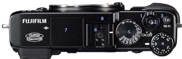
Abb. 2: Draufsicht der X-E2: Ein-/Aus-Schalter (1), Auslöser mit Gewinde für Drahtauslöser (2), Fn/Wi-Fi-Taste (3), Belichtungskorrekturrad (4), Belichtungszeitwahlrad (5), Blitzschuh (6), Ausklappblitz (7), Mikrofon links/rechts (8).
