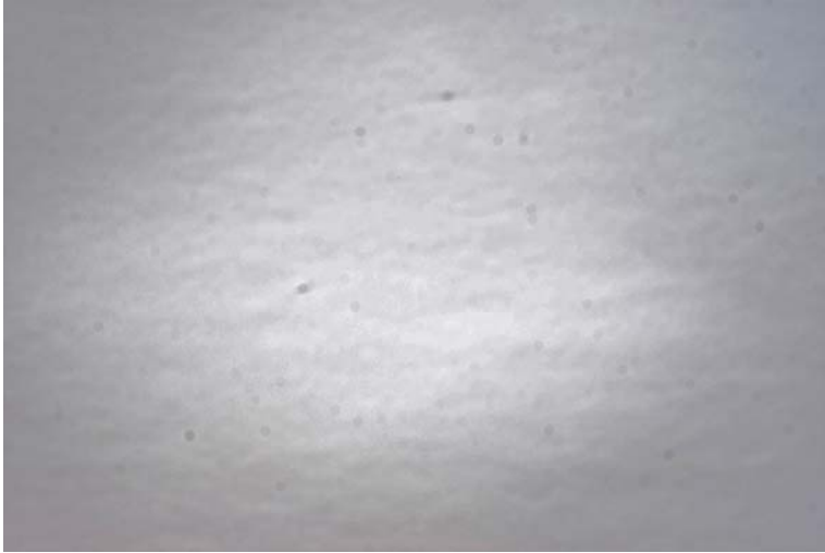
Abb. 7: Sensorflecken – sichtbar gemacht mit verstärkten Kontrasteinstellungen am PC. Hier hilft nur noch eine Feuchtreinigung des Sensors.
