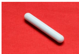
Abb. 1.3.2: Rührfisch: vollummantelter Stabmagnet
