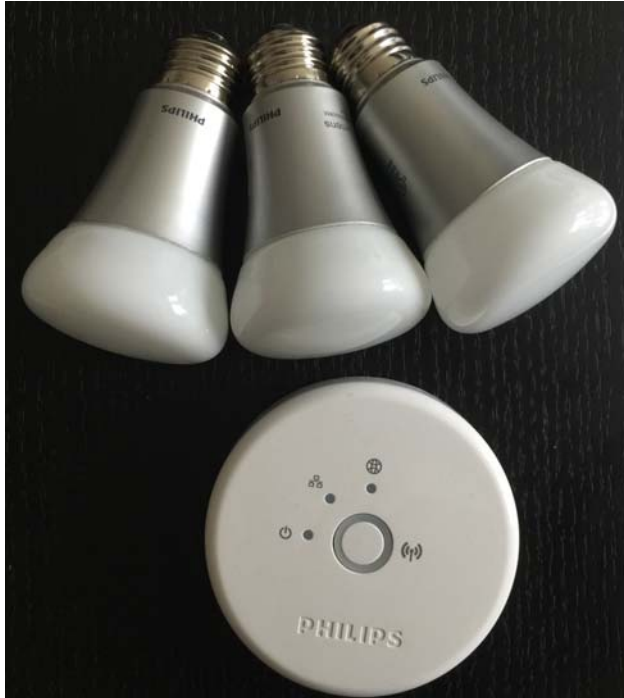
Abb. 1–1 Hue-Starterpaket mit Bridge und drei funksteuerbaren Leuchtkörpern
