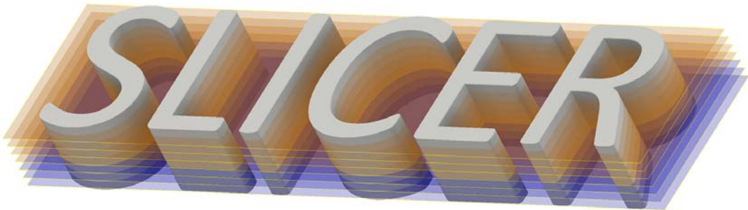
Abb. 1–7 Zerlegung eines 3D-Objekts (Schriftzug) in Scheiben
