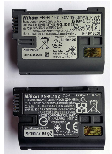
Unten der neue Akku EN-EL15c, der etwas mehr Power als der (kompatible) Vorgänger EN-EL15b mitbringt.
