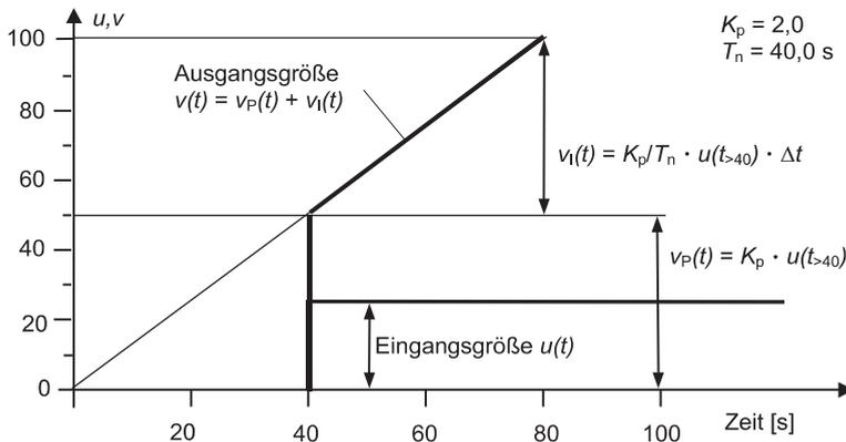
**Bild 1.3** Die Sprungantwort eines PI-Reglers im geöffneten Regelkreis
