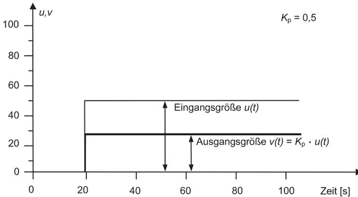
**Bild 1.2** Die Sprungantwort eines P-Reglers im geöffneten Regelkreis
