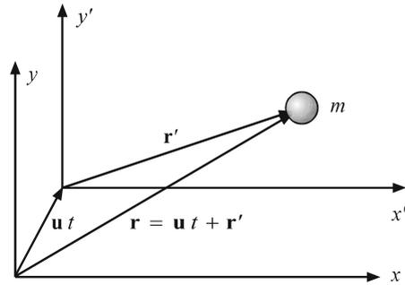
**Abb. 1.1-1** Die beiden Bezugssysteme  $S$  und  $S'$  haben eine konstante Relativgeschwindigkeit  $\mathbf{u}$ , so dass Ortsvektoren und Geschwindigkeiten in beiden Bezugssystemen verschieden sind, nicht aber die Beschleunigungen.
