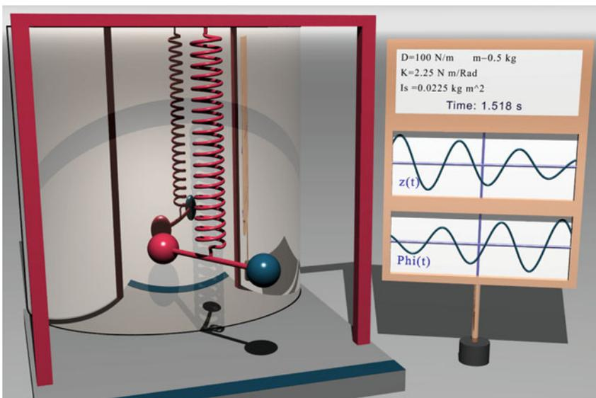
**Wilberforce-Pendel.** Hier treten schwebungsartige Wechsel zwischen vertikalen Federschwingungen und Torsionsschwingungen auf.
