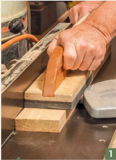
Beim Abrichten der ersten Fläche ist der Arbeitstisch der Abrichthobelmaschine die Bezugsfläche. Wenn das Material die Hobelwelle passiert hat, übt man Druck nach unten auf den Abnahmetisch aus.
