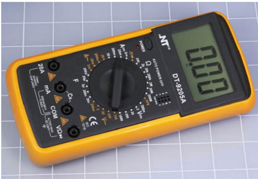
**Abbildung 1–3.** Ein Messgerät mit manueller Bereichswahl
