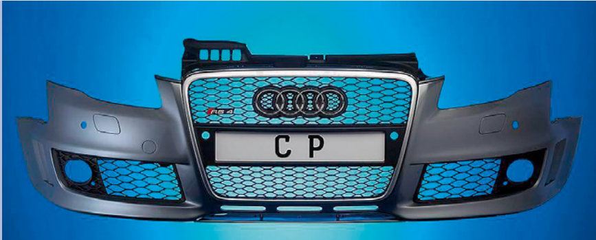
Bild 1.4 Modifizierter Frontspoiler für eine Fahrzeugsonderedition; Laser-Stereolithographie, RTV und Polieren, Lackierung (Quelle: CP-GmbH)
