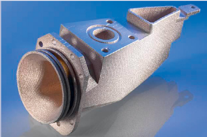
Bild 1.5 Heißluftkanal für eine Luftfahrtturbine, 3D Printing (Metall), Nachbehandlung (Quelle: FhG-IFAM/Airbus)
