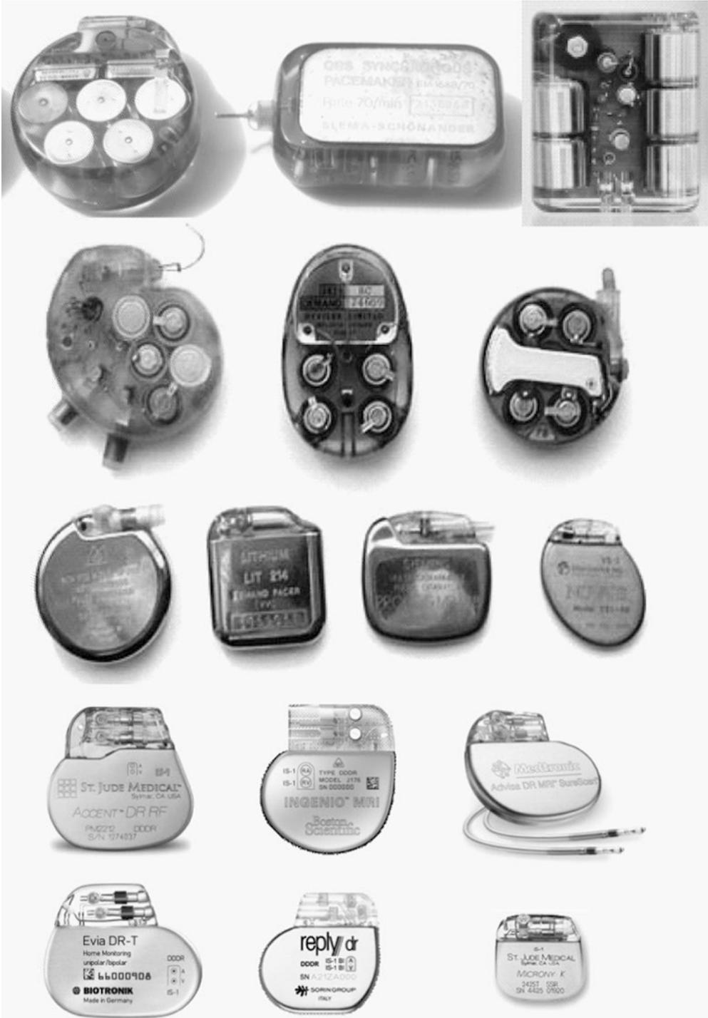
▣ **Abb. 1.2** Entwicklung der Schrittmachergehäuse: von den Anfängen der Schrittmachertherapie bis 2010. Dieses Bild ist eine Fotomontage und zeigt nur
