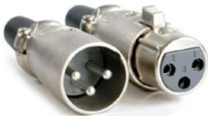
Figura 5: ① Cuerpo: tierra (pantalla, *shield*). ② *Hot*: canal izquierdo. ③ *Cold*: canal derecho.
