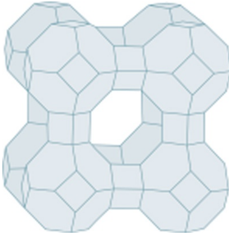
Hohlraum im Klinoptilolith-Kristallgitter
