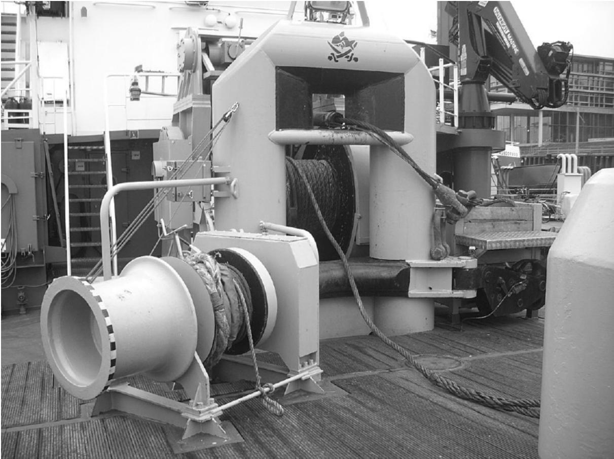
*Die große Schleppwinde trägt zwei Trommeln, die versetzt übereinander angeordnet sind. Daher auch der Name "Wasserfallwinde". Ebenfalls zur Ausrüstung gehören eine seitlich angebrachte Hilfswinde (Tugger-Winde), ein Schlepphaken und ein hydraulischer Ladekran.*
