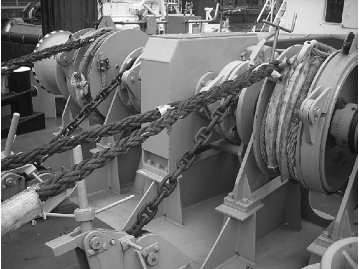
*Auf dem Vorderdeck, zwischen Wellenbrecher und Bugverschanzung, ist eine kombinierte Anker-und Verholwinde aufgebaut.
