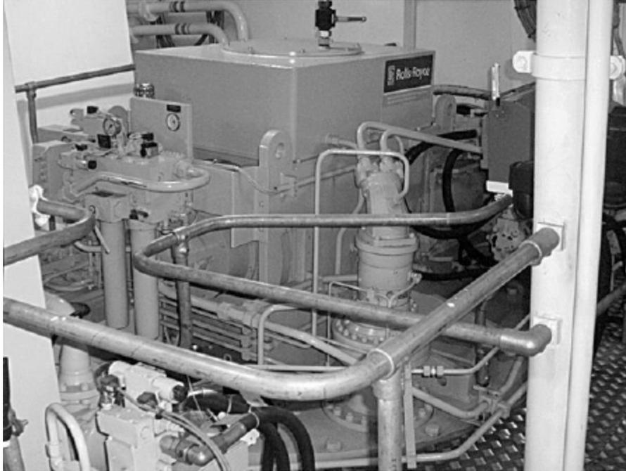
*Jedes Ruderpropellersystem vom Typ Rolls Royce-Aquamaster US 305 bildet eine Einheit aus Antriebsschraube, Kort-Düse, Ruderschaft, Lager, Dichtungen, Getriebe und hydraulisch betriebenen Steuerantrieben. Hier ist das obere Getriebegehäuse zu sehen.*
