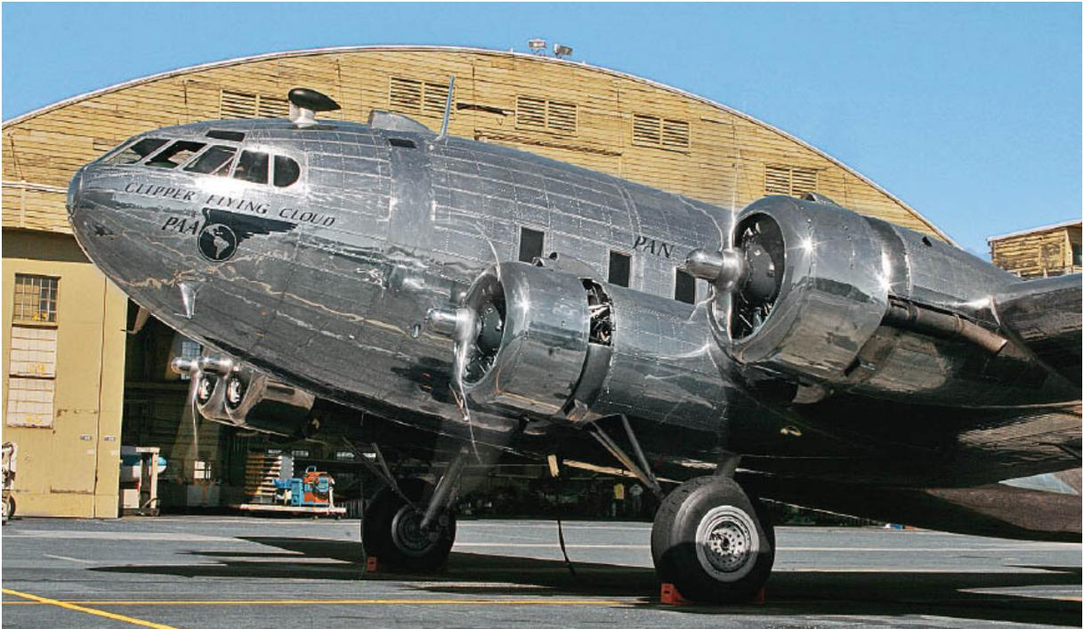
Die Boeing 307 verfügte als erstes Verkehrsflugzeug über eine Druckkabine.
