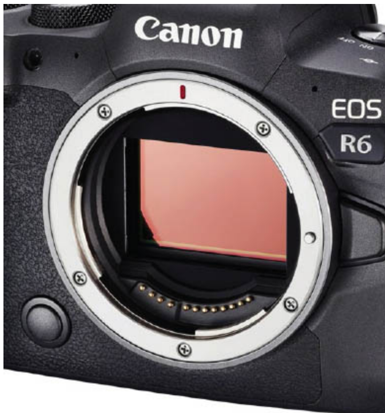
Abb. 1.6 Das Bajonett der EOS R6 mit freiliegendem Sensor – die Kamera ist eingeschaltet. (Foto: Canon)
