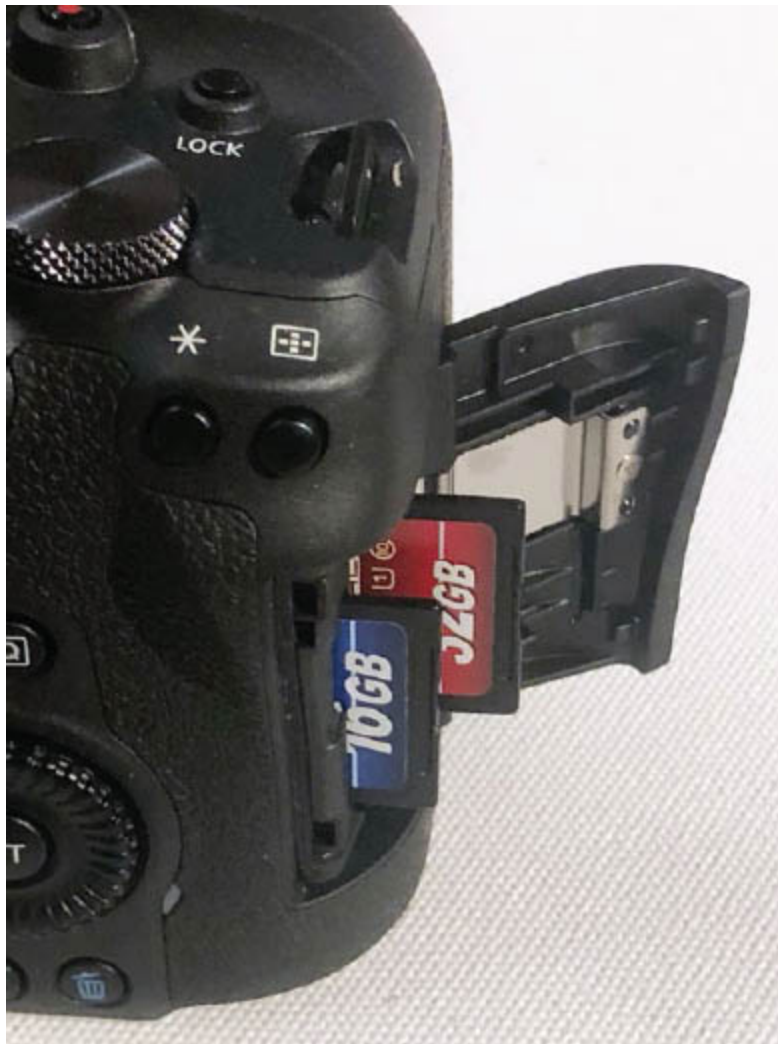
Abb. 1.5 Die EOS R6 besitzt zwei Kartenschächte. Der auf dem Bild vordere Schacht ist Schacht 1.
