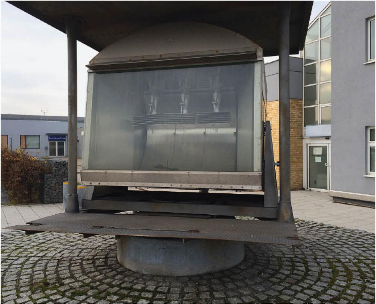
Leuchtturm aus dem Jahr 1939. Drei dieser Hochleistungsstrahler wiesen einst den Piloten den Flugweg zum Leipziger Flughafen. Die Scheinwerfer waren hydraulisch in der Erde versenkbar. Als dieses Exemplar fünfzig Jahre später geortet und ausgegraben wurde, funktionierte die Hydraulik noch immer!
