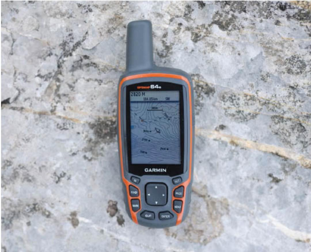
*Garmin-Navigationshandgeräte wie das GPSMAP 64s sind mit einem 2,6-Zoll-Display ausgestattet, das selbst bei Sonneneinstrahlung gut ablesbar ist. Die Antenne sorgt für einen ausgezeichneten Empfang. Das Gerät umfasst einen barometrischen Höhenmesser und einen 3-Achsen-Kompass.*
