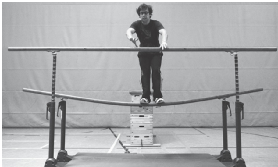
Abb. 10: Zu hohe Belastungen können zum Holmbruch führen.
