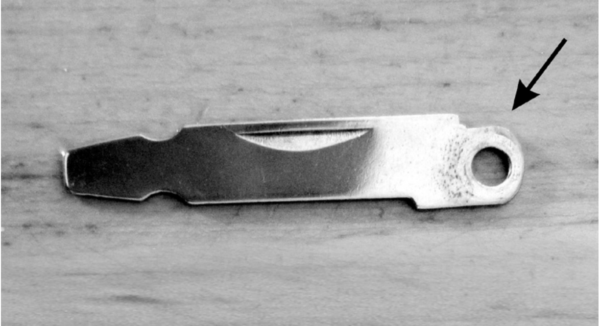
Abb. 9: Die Klingenwurzel der ausgebauten Werkzeuge, insbesondere Lage und Durchmesser des Achslochs sowie die Aussparung für die Rückenfeder (Pfeil) dient als Grundlage für die neu herzustellenden Klingen. Dieser Bereich sollte so genau wie möglich kopiert werden.
