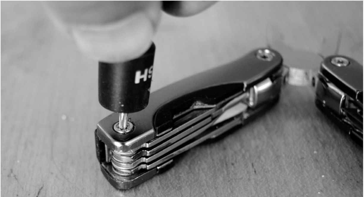
Abb. 7: Bei verschraubten Achsen ist das Auswechseln von Werkzeugen ein Kinderspiel – sind die Stifte jedoch vernietet, müssen die Nietköpfe abgeschliffen und die Achsen mit dem Splintentreiber herausgestoßen werden.
