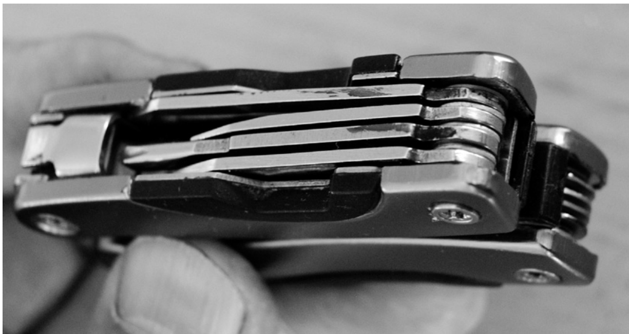
Abb. 6: Wer Werkzeuge an herkömmlichen Multitools durch andere ersetzen will, muss erst einmal prüfen, wie diese befestigt sind. Anschließend wird ermittelt, wie viel Platz für die neuen Klingen zur Verfügung steht.
