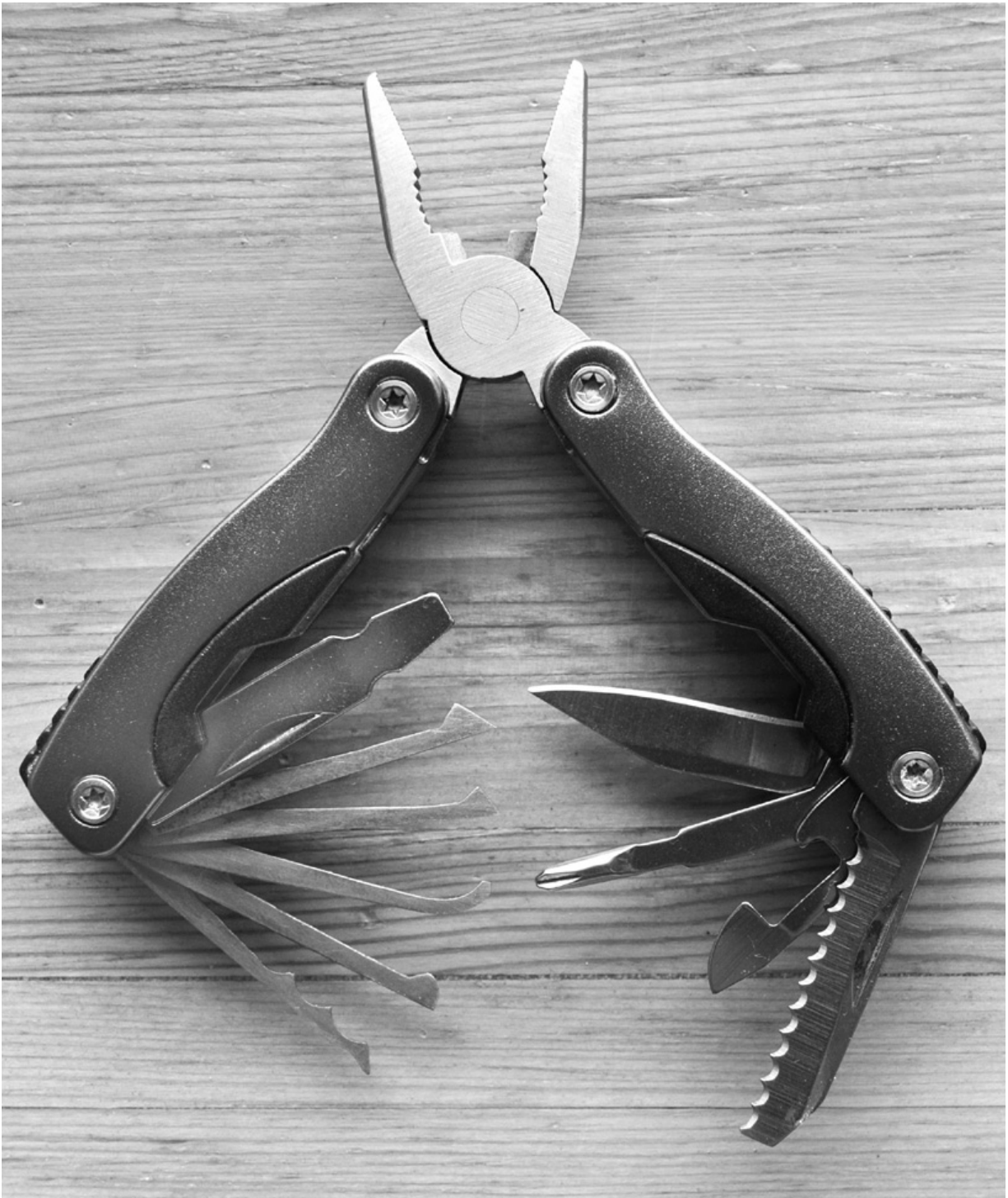
Abb. 5: An diesem Multitool aus dem unteren Preissegment wurden unbrauchbare Klagen entfernt und durch einen Satz Werkzeuge zum zerstörungsfreien Öffnen von Profilzylindern ersetzt. Dadurch wird aus einem ansonsten eher durchschnittlichen Tool ein wertvoller Begleiter für Mitarbeiter von Schlüsseldiensten.
