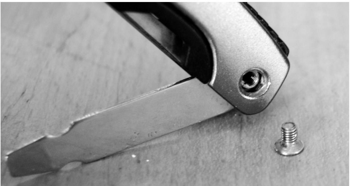
Abb. 8: Ist die Halteschraube gelöst, kann die verbleibende Hülsenmutter zur anderen Seite herausgestoßen werden. Danach fallen die Werkzeuge, getrieben von der Kraft der Rückenfeder, meist von alleine heraus.
