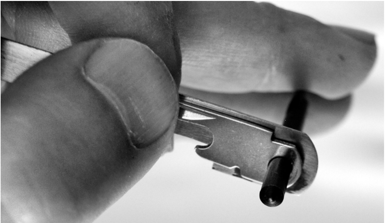
Abb. 10: Das Material für die neuen Klingen wird zunächst mit einem Achsloch im passenden Durchmesser versehen. Dann wird ein passender Stift eingesetzt und die alte Klinge aufgeschoben - auf diese Weise lassen sich die Abmessungen der Klingenwurzel mit der Reißnadel wie entlang einer Schablone übertragen.
