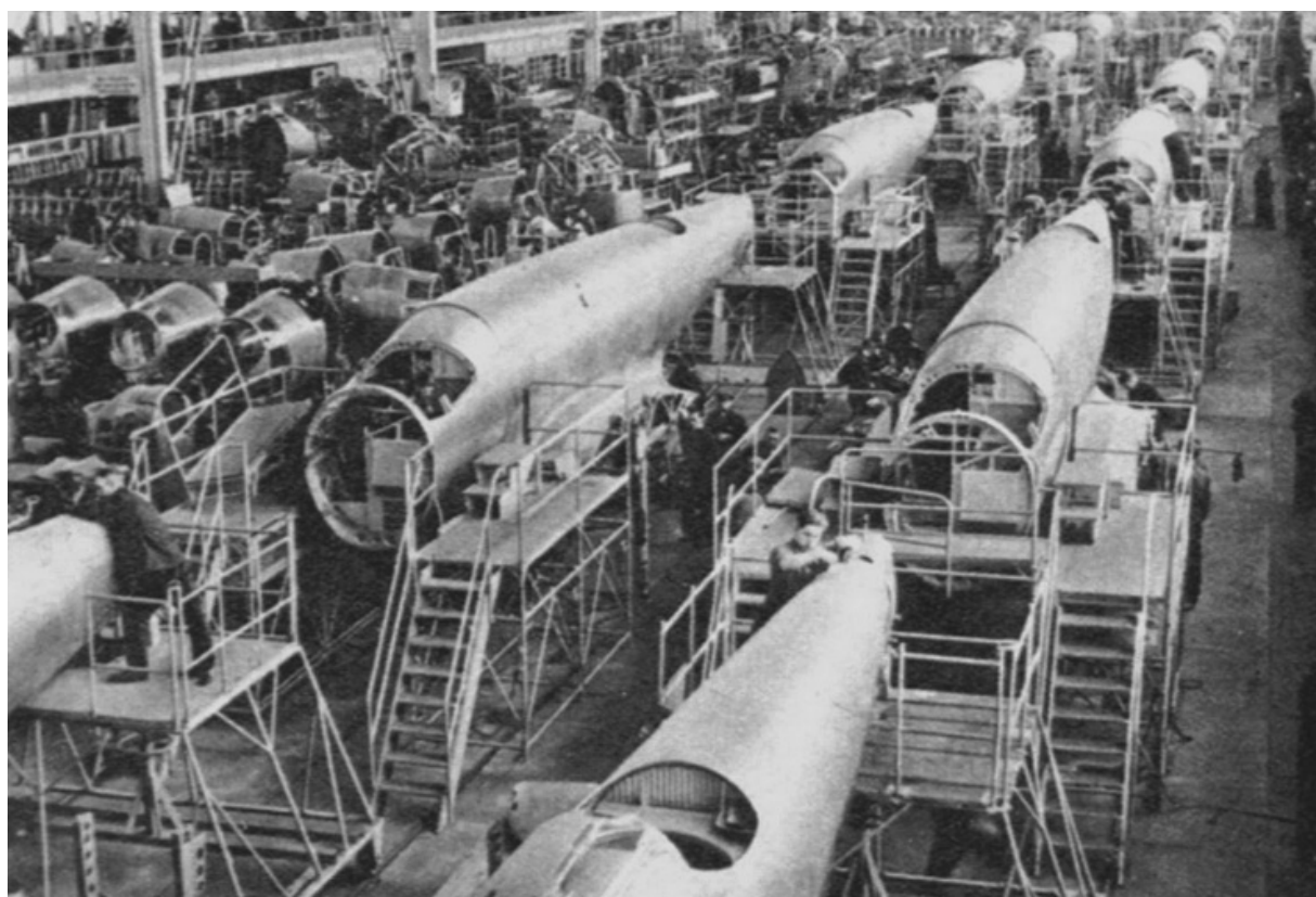
Junkers Ju86 Rumpffertigung bei Junkers in Dessau (JFM)
