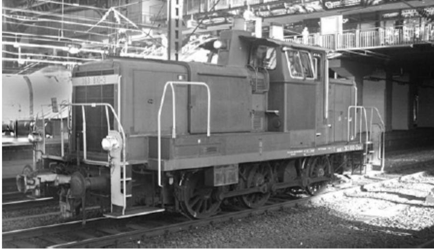
*Der Vergleich mit einer Lokomotive mag wohl hinken. Dennoch gibt es Parallelen. Beides sind Zugmaschinen. Die Rangierlok der Baureihe 363 hat eine Motorleistung von 632 PS. Der Schlepper verfügt über 600 PS. Die Lok ist kleiner und leichter als das Schiff. Ihre Zugkraft liegt mit 132 kN (entspricht etwa 13 t) um einiges höher als die des Schleppers. Dessen Pfahlzug beträgt schätzungsweise etwa 8 t.*
