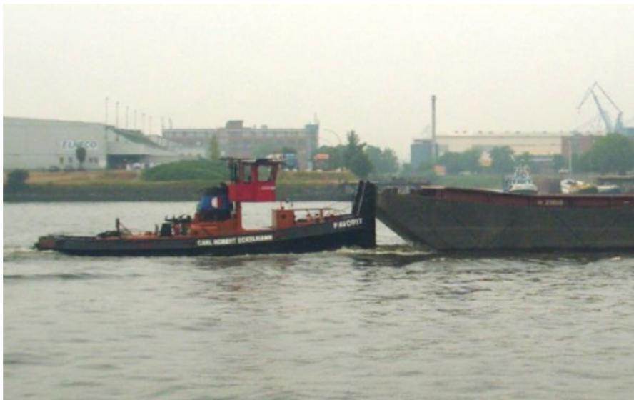
*Zwei lange Schubschultern gewährleisten auch bei leeren Leichtern einen guten Kontakt. So wird ein gefährliches Unterlaufen der Schiebelast vermieden.*
