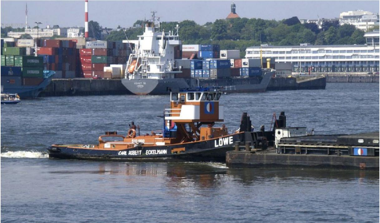
*Schubschlepper LÖWE dreht im Vorhafen mit einem beladenen Leichter nach steuerbord.*
