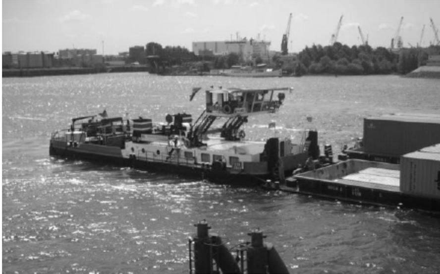
*Das Schubschiff SCH 2640 der Deutschen Binnenreederei wurde für längere Reisen entworfen und bietet daher auch mehr Raum für die Unterkünfte der Besatzung.*
