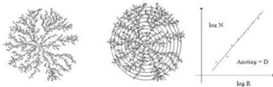
Abb. 3. Fraktale Dimension komplexerer zweidimensionaler Strukturen. Links - Witten-Sander-Modellcluster, Mitte - Zählmethode zur Berechnung der fraktalen Dimension, rechts - Ausgleichsgerade zur Ermittlung von D .
