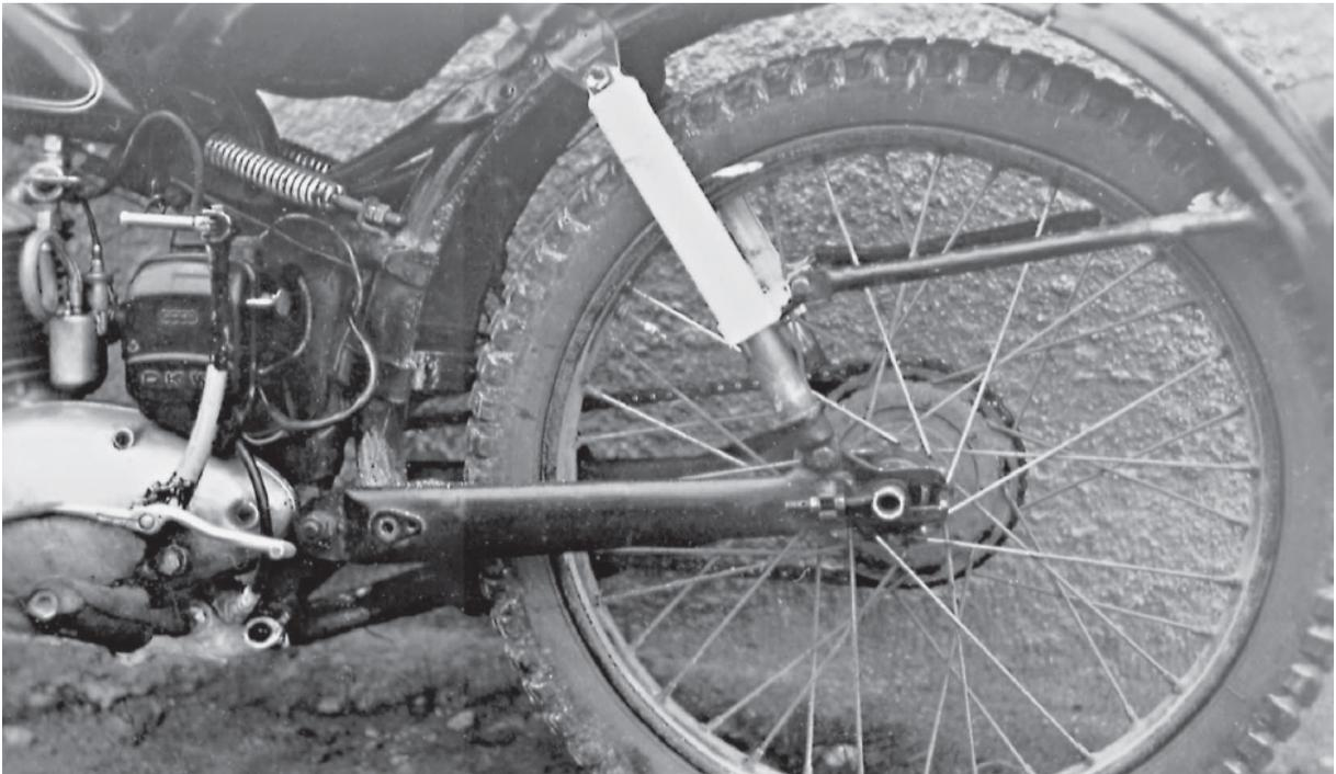
*DKW RT 125 mit selbstgebauter Hinterradfederung*
