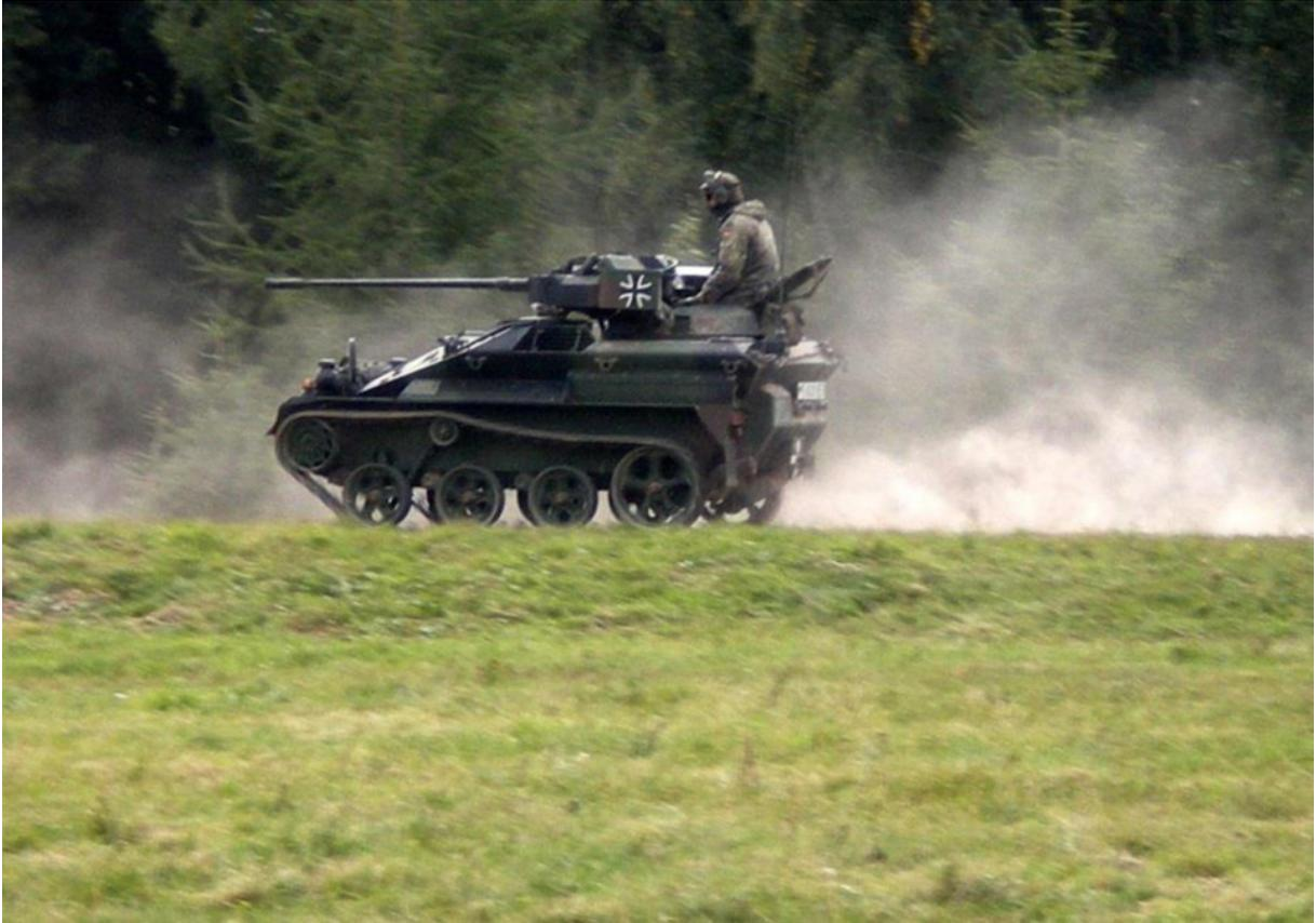
***Waffenträger WIESEL, des Fallschirmjägerbataillons 263 aus dem saarländischen Merzig, ist mit einer 20mm-Maschinenkanone ausgerüstet (Fotograf: Uwe Walter)***
