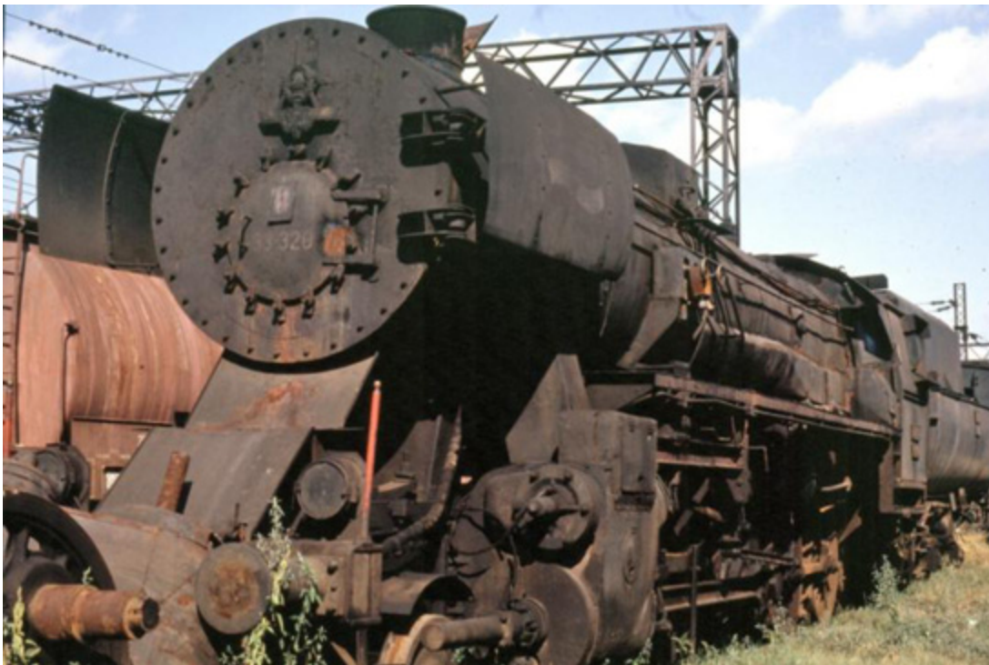
Abb. 3: Die von der Sowjetischen Staatsbahn „verteilten“ 52er - wie die Kreka 503-505 - erhielten diverse Umbauten, so auch eine kleine Rauchkammertür. Die Kreka-Loks trugen diese bis weit in die 90er Jahre hinein. Foto: Manfred Britz, 1986
