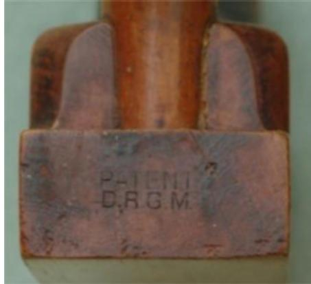
Der patentierte angeformte Schlagknopf (von Johann Weiss Patentnummer AT0000042079B) verhinderte das Splintern des Hobelrückens beim Einstellen des Hobeisens. Später wurde der Schlagknopf durch einen eisernen ersetzt.
