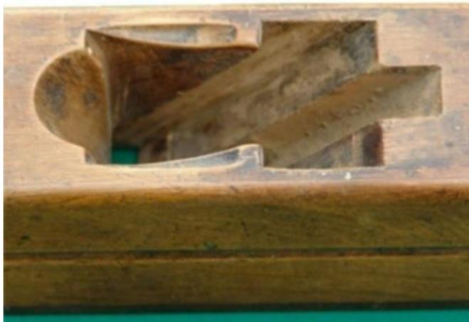
Form D. Flir mit Nut für die Stellschraube.
