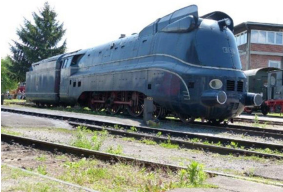
Die geplante Zukunft der Baureihe 01. Die Baureihe 01.10 (01 1102) mit Drillingstriebwerk und Stromlinienverkleidung in Heilbronn Foto: Markus Urbanczyk
