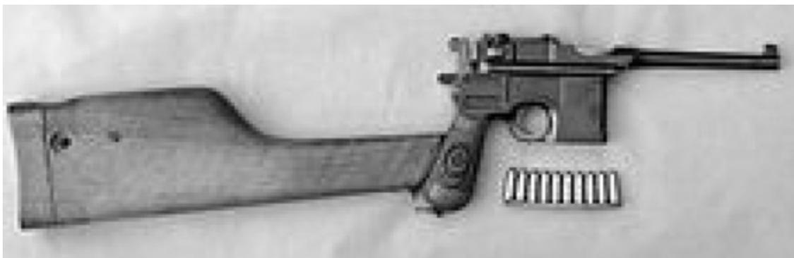
Die C96 ist ein Rückstoßlader mit gerade zurücklaufendem Lauf, Schwenkriegelverschluss und außenliegendem Hahn. Der Magazinkasten ist vor dem Abzugsbügel angeordnet und wird von oben mit Ladestreifen geladen. Mit dem Modell 1930 führte Mauser Wechselmagazine mit unterschiedlicher Kapazität ein. Das Modell 1932 war in der Lage, optional auch Dauerfeuer zu schießen. Das Futteral der Waffe konnte bei allen Modellen als Anschlagschaft verwendet werden.
