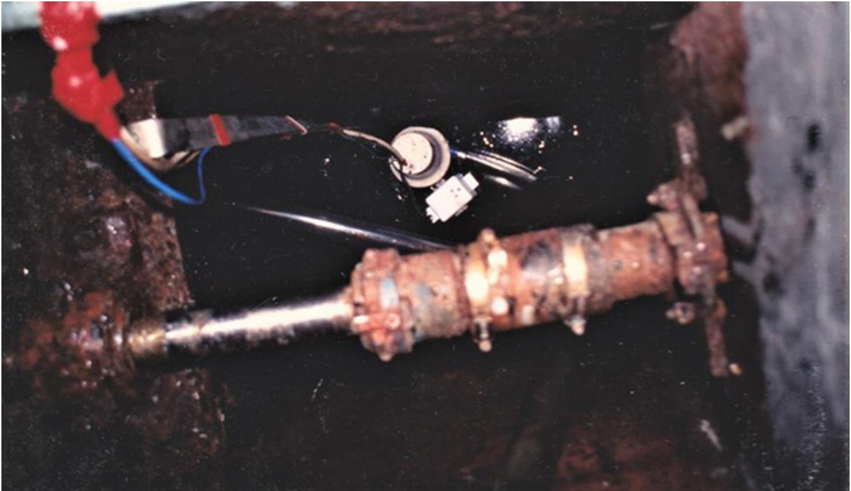
*Bilgepumpe nun 130 cm tief unten auf ein Flacheisen montiert*
