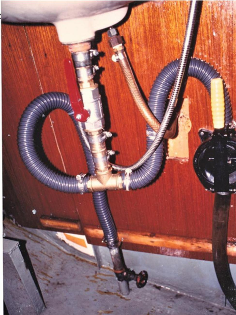
*Abfluß mit Ventil und Handbilgepumpe installiert*
