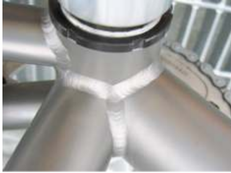
Unión soldada de piezas de aluminio
