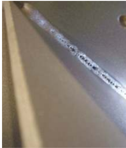
Porosidad en un cordón de soldadura
