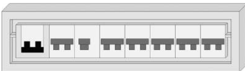
Figura 1.7. Cuadro de protección de una vivienda
