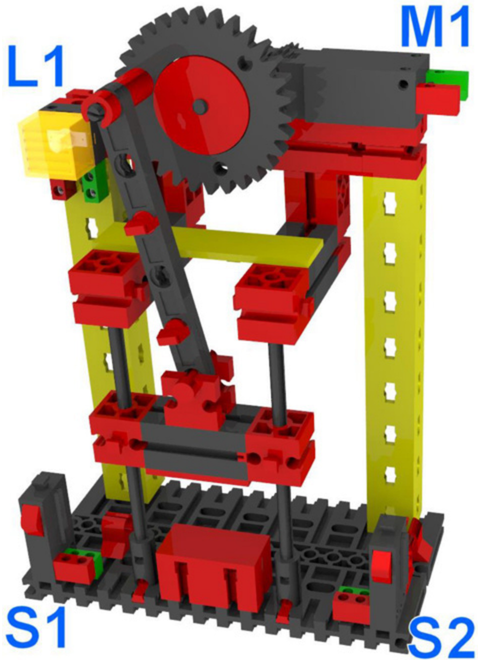
Manuelle Stanzmaschine bei der das Werkstück von Hand eingelegt wird
