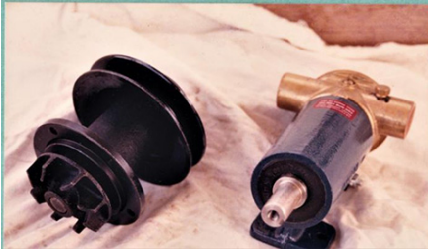
Neue Süßwasser- → u. Meerwasser- pumpe in reserve!
