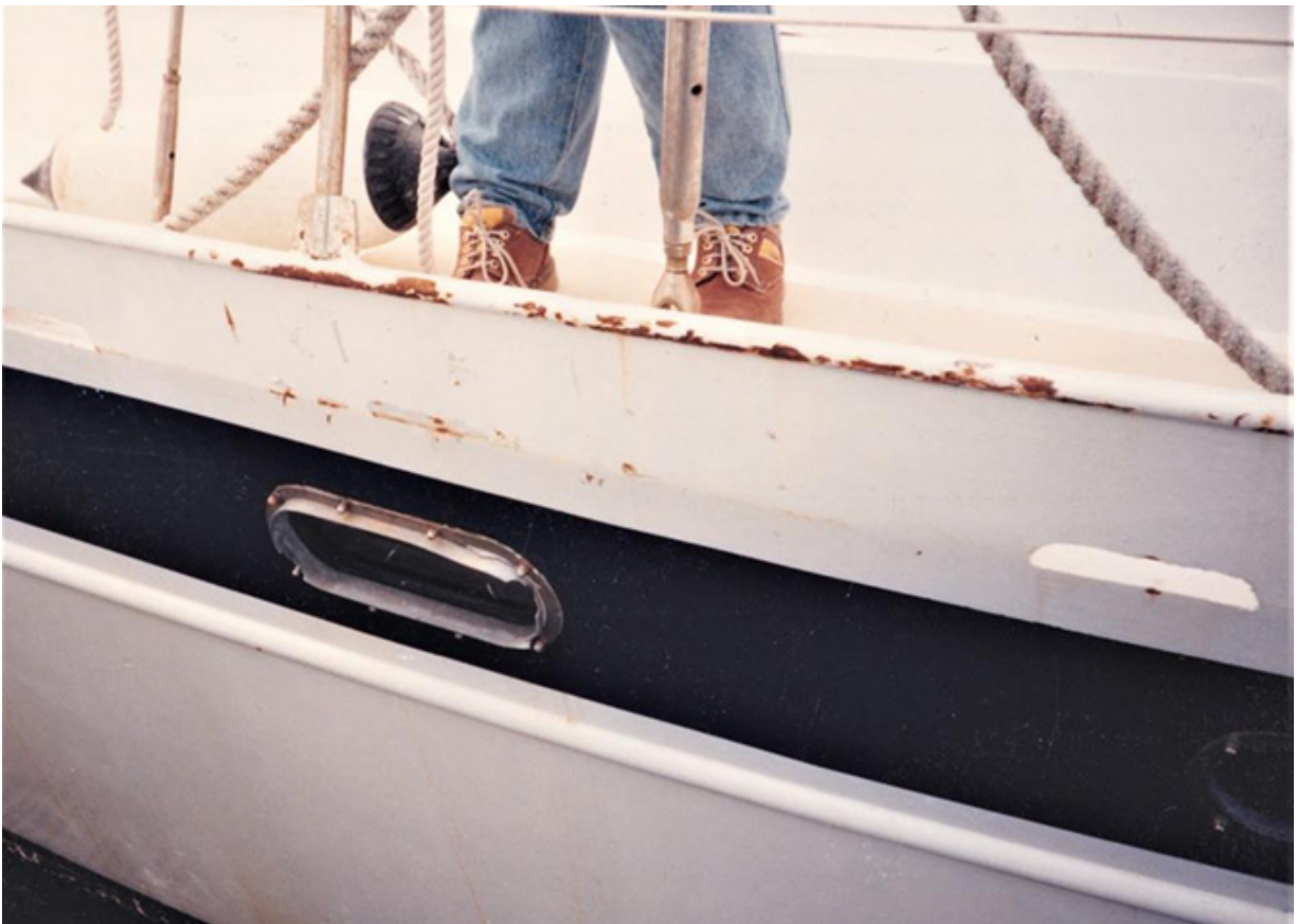
Luke bei Sturm am 27. Jänner 1995 in Marina Pula gebrochen und das Schanzkleid eingedrückt und schon rostig geworden.
