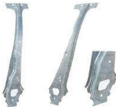
Refuerzo del pilar central
