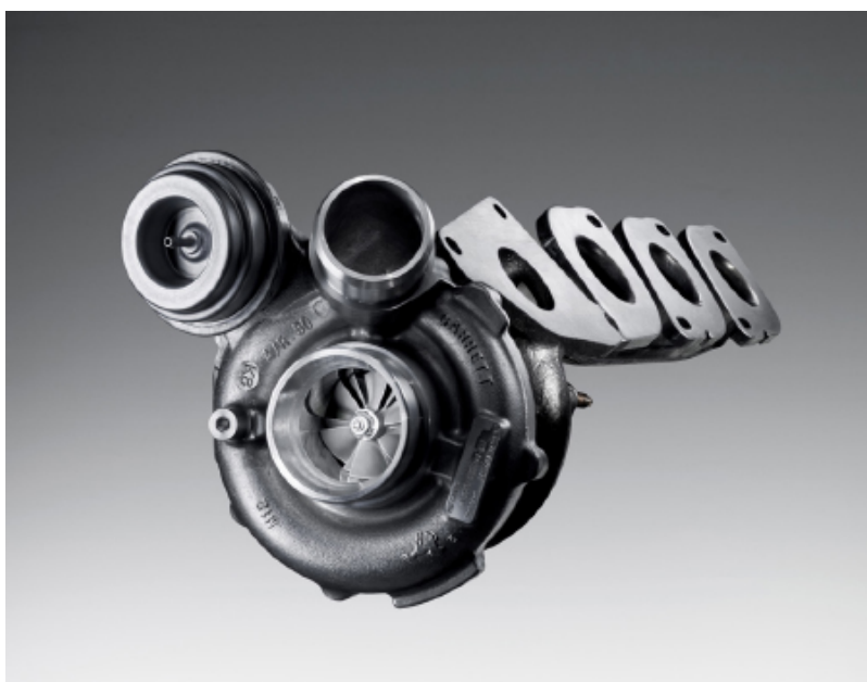
(Turbolader mit verstellbaren Schaufeln und Abgaskrümmen einer vierzylindrigen Motorbank)
