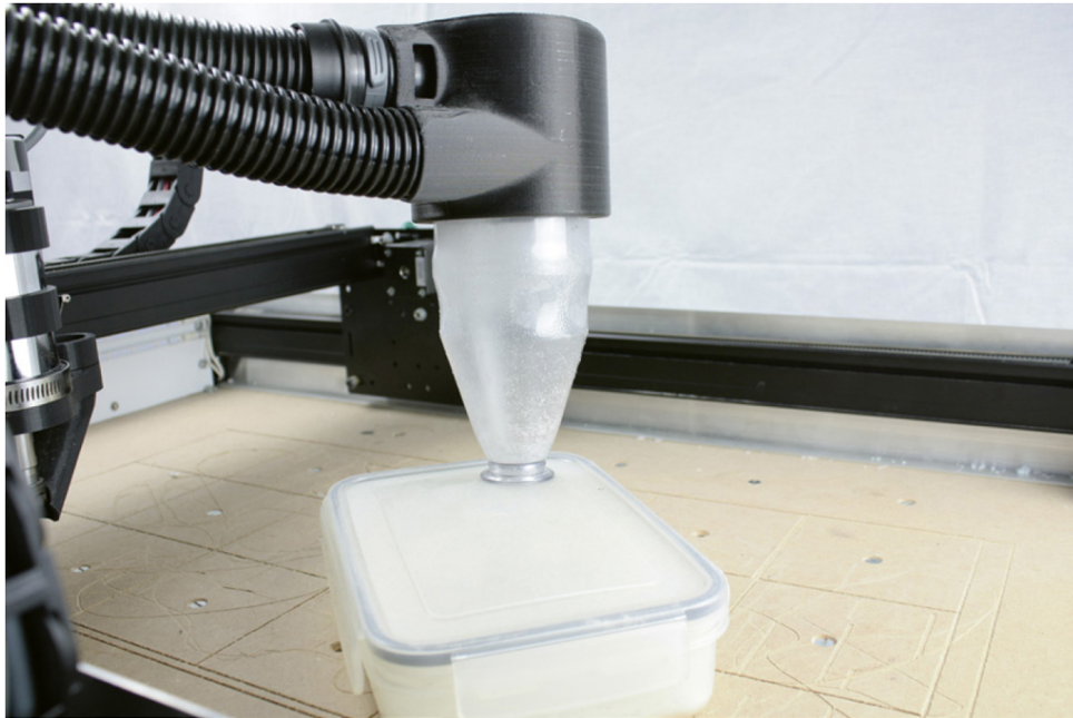
Bild 1.10 Sorgt für Sauberkeit am Arbeitsplatz: ein selbst gebauter Zyklonabscheider
