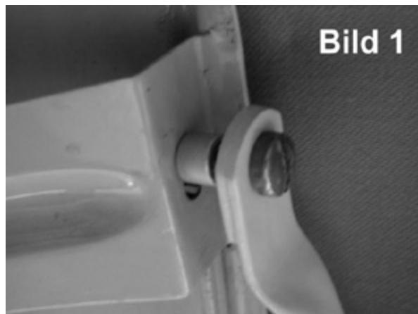
Wenn wir die beiden Lagerschrauben rechts und links innen über den Seitenfenstern herausgedreht haben, die dem vorderen Verdeckspiegel als Drehpunkt dienen, wird das
