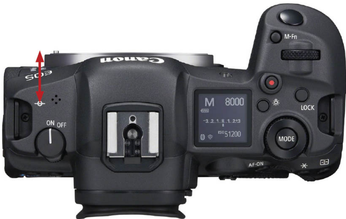
Abb. 1.7 Der Sensor der EOS R5 sitzt im Gehäuse recht weit vorn (siehe Markierung der Sensorebene), daraus resultiert das geringe Auflagemaß. (Foto: Canon)
