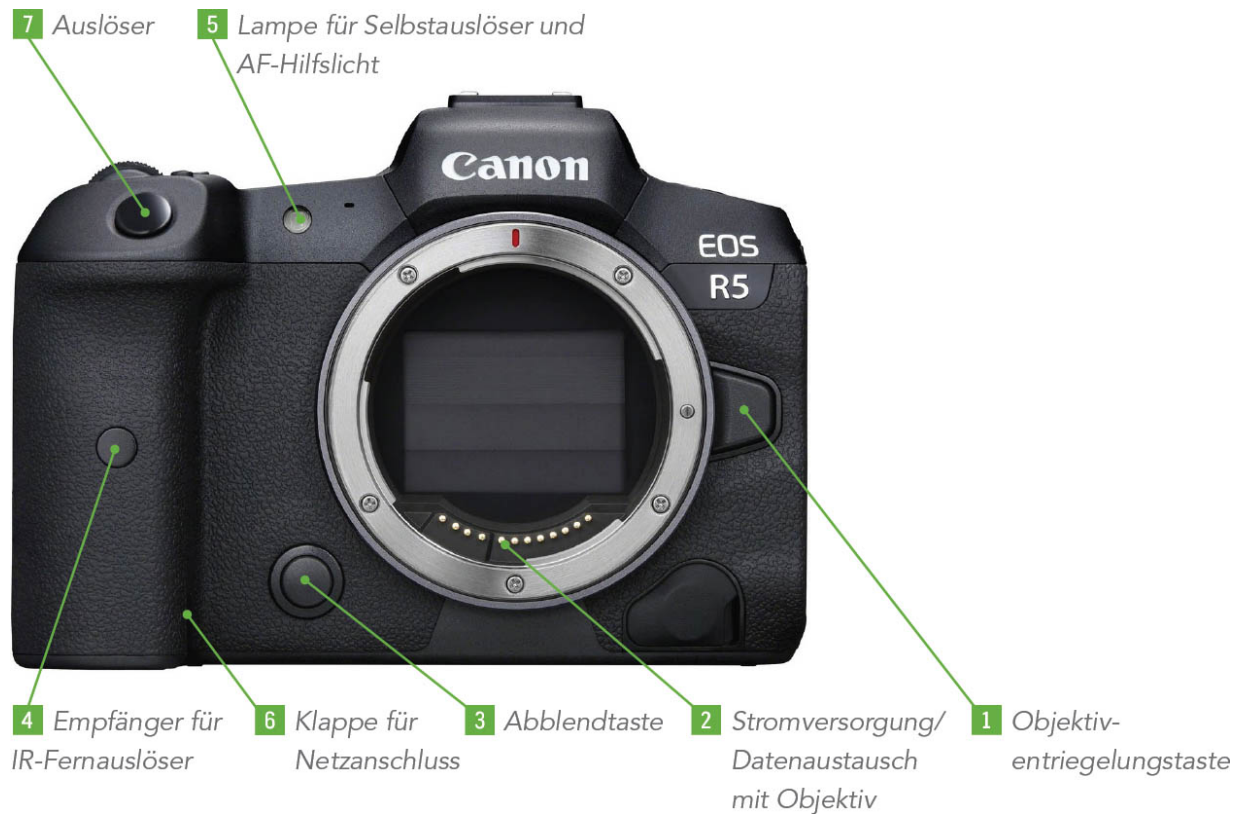
Abb. 1.1 Die Vorderseite der EOS R5 mit geschlossenem Verschluss. Ist die Kamera ausgeschaltet, wird der Sensor durch den mechanischen Verschluss verdeckt. (Kann eingestellt werden) (Foto: Canon)
