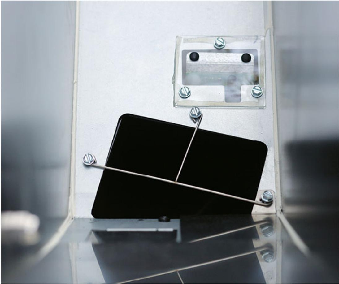
**2.** Den Trichter der Pelletkammer öffnen. Der Fingerschutz sorgt für den nötigen Schutz, damit man beim Ein- und Nachfüllen der Pellets nicht in den Bereich der Förderschnecke gelangt. Der darüber befindliche Sensor überwacht die Füllmenge und meldet, sobald nicht mehr ausreichend Pellets zur Verfügung stehen.
