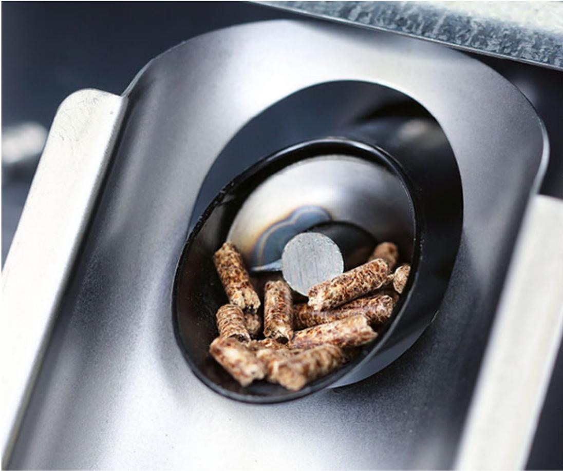
**5.** Die Förderschnecke transportiert die Pellets aus dem Trichter in die Brennkammer. Je nach Höhe der eingestellten Grilltemperatur fallen mehr oder weniger Pellets in die Brennkammer.
