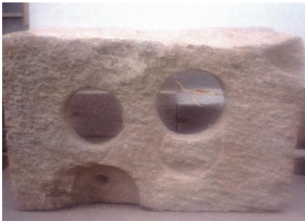
Stein mit Probebohrungen
