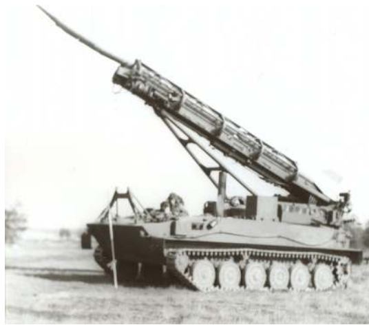
Startrampe 2P16 und Rakete 3R9 des Raketenkomplexes 2K6 LUNA in der Startstellung, *2
