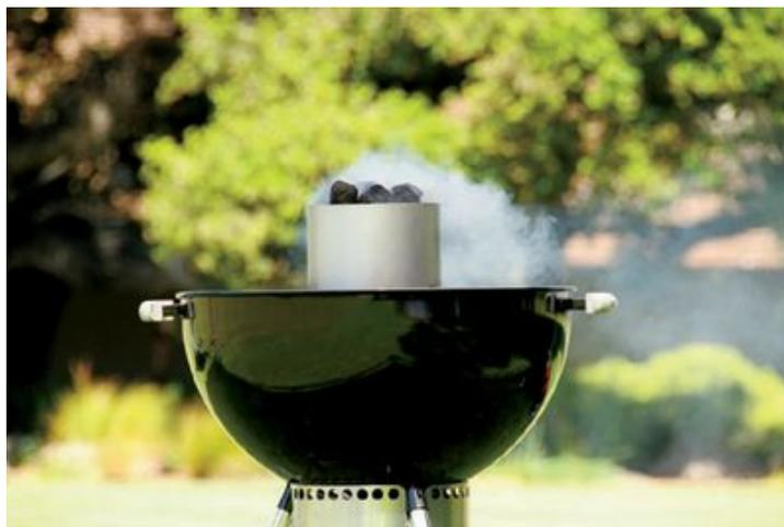
**2** Sobald die Anzündwürfel brennen, wird Luft von unten angesaugt, wodurch sich die Hitze von unten nach oben gleichmäßig auf die Kohlen ausbreitet.
