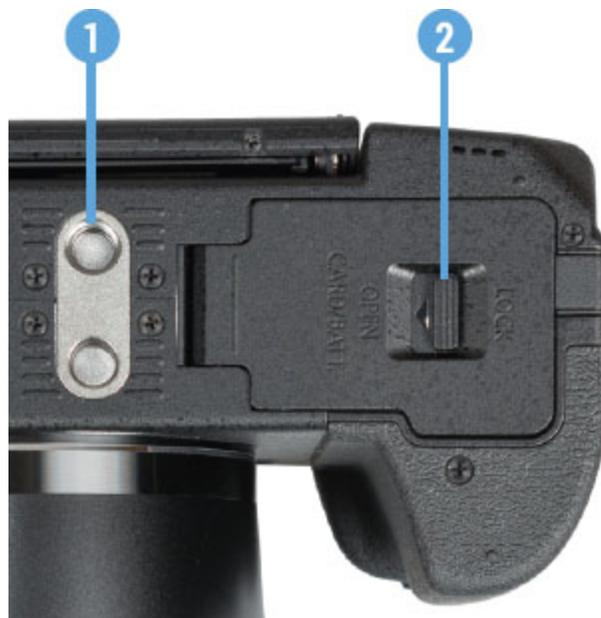
*Elemente an der Unterseite der G3 X*
